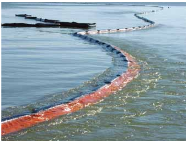
▲ 图 4：充分认识到设备的局限性及将部署到的环境的限制，将帮助确保避免将时间和精力浪费在可以预见不会起作用的行动上。这里的高水流意味着浮木档栅不能围堵油类。
