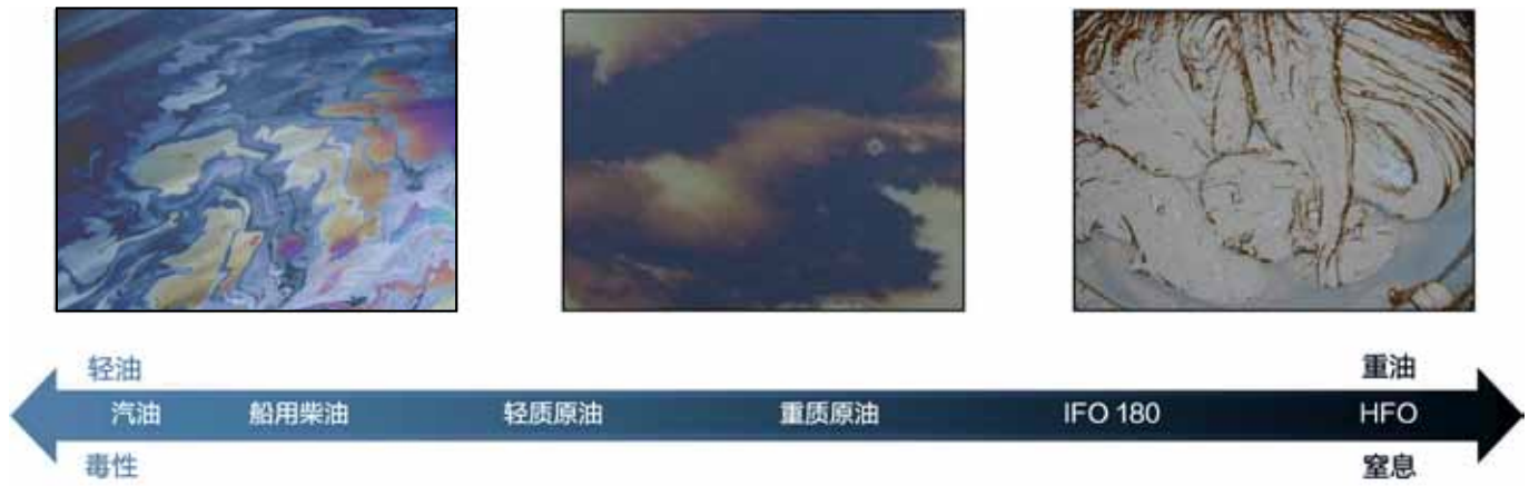
▲ 图 2: 对海洋生物体的典型影响很多, 从毒性 (尤其轻质油类和油类产品) 到窒息 (中质和重质油类 (IFO 和 HFO) 及风化残渣) 均有可能。
