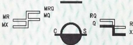
客船分舱干舷C1 505 毫米, C2 --- 毫米, C3 --- 毫米
