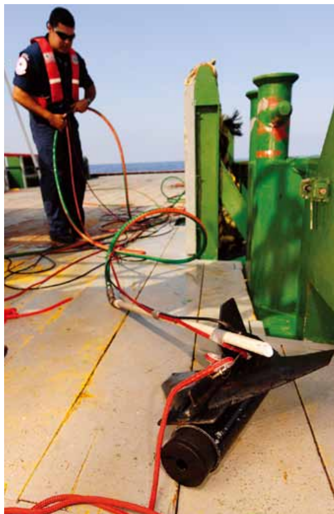
▲ 图 13：正在准备用来在海上测量消散剂效果的拖拽式荧光计。（图片由 USCG 惠供）。
