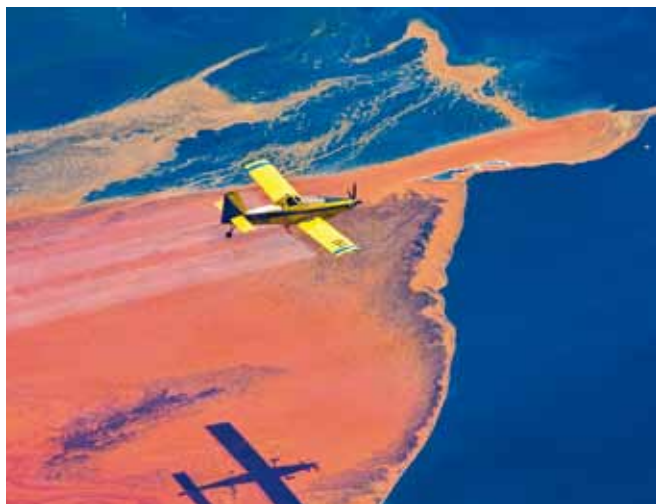
▲ 图 9：一架农用飞机正在从机翼下的喷杆向从一个海上平台泄漏的原油喷洒消散剂。（图片由 Mark Hamilton Photography 惠供）。
