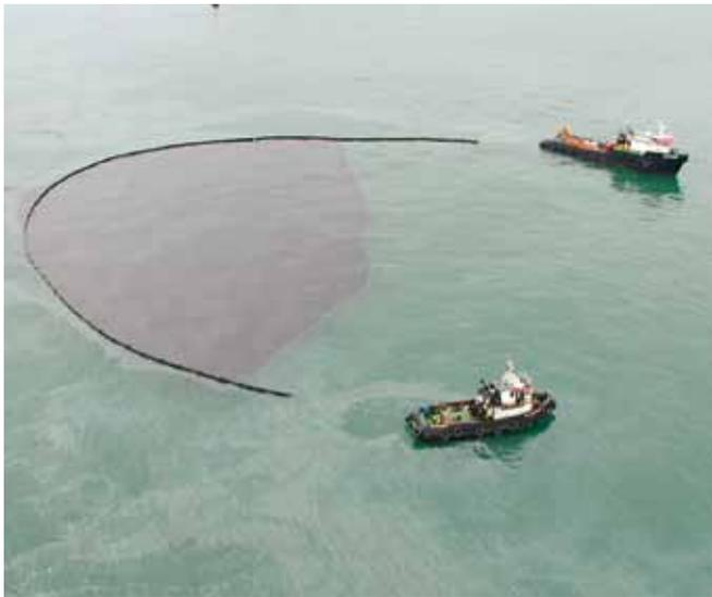
▲ 图 8：为围堵某种重质原油而在两艘船之间以 U 形配置部署的充气式栅栏。回收这些油后，此项作业便圆满成功。
