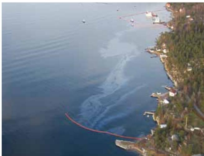
▲ 图 14：栅栏起到堤坝的作用，引导油类流向海岸以便回收（© 挪威海岸管理局版权所有）。
