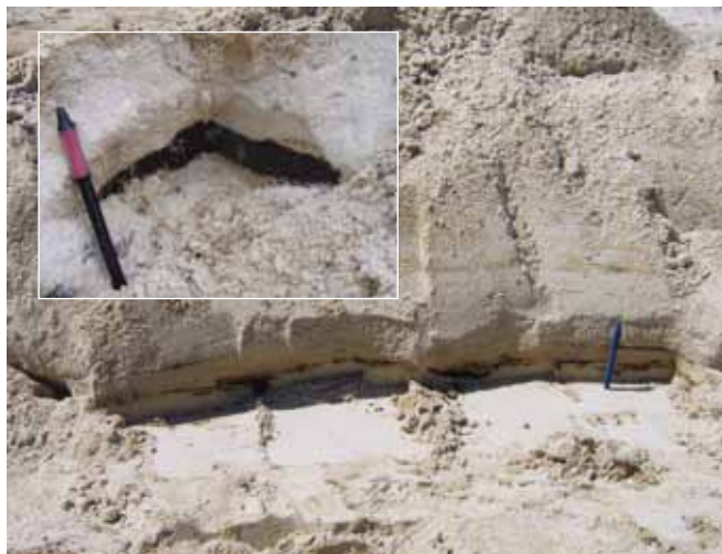
▲ 图 12：因受到波浪作用而被埋在干净沙子之间的油层。
