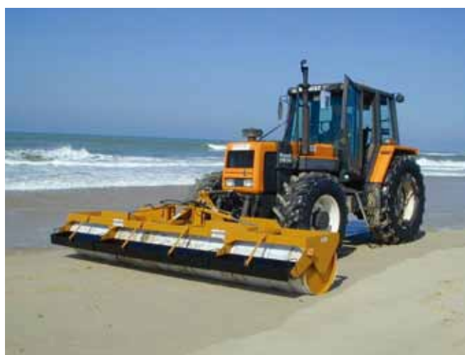
▲ 图 36：安装在拖拉机上的亲油性筒式撇浮装置，用于在结构紧密的沙滩上回收新鲜油块（图片由 Le Floch D 隔ollution 惠供）。
