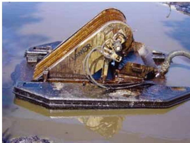
▲ 图 5：自由漂浮的刷式撇浮装置。油类附着在转动的成组刷子上，并从水面上被提起。用一个梳子将油类从刷子上清除到存储容器中。刷子背后的推进装置将浮油推往撇浮装置以提高遇油率和吞吐量（图片由 Lamor 惠供）。
