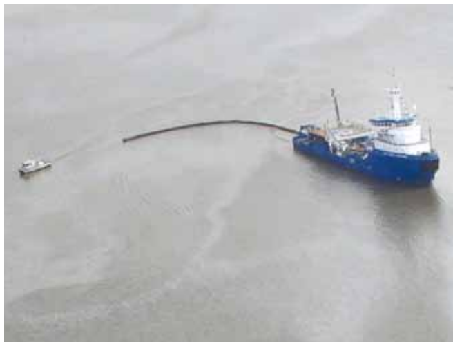
▲ 图 29：以 U 字形拖拽的栅栏，带有一个从主回收船部署的撇浮装置。
