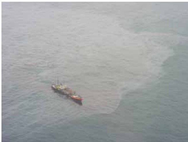
▲ 图 18：一艘回收船位于大面积、均匀且厚实的油类漂浮层中，这种情况可以使资源得到极为有效的利用。
