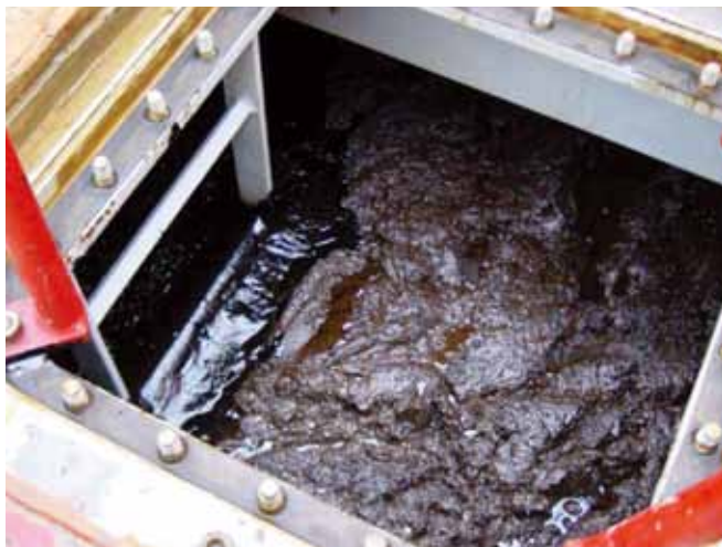
▲ 图 25: 回收船上一个储放罐中回收的高粘度油类（图片由 NOFO 惠供）。
