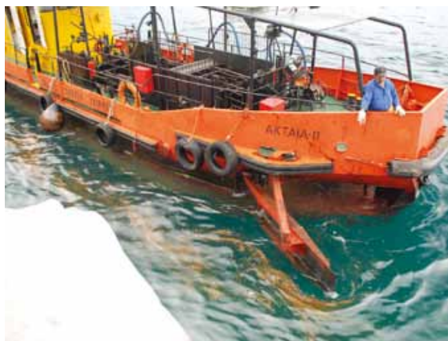
▲ 图 1：一台自力推进型导流坝撇浮装置，供在港口和近岸水域中使用。船首门已打开，以增大扫过的油带宽度并使浮油能够进入。回收到的油类会泵送到一个内部储放罐中。
