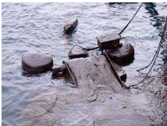
▲ 图 16: 增添了一个带子适配器以提升基本导流坝撇浮装置在高度乳化的燃油中的处理能力。这种油由于具有高粘度, 因而无法流向导流坝, 也无法从导流坝的边缘上方流过。而带齿的带子适配器则可以“抓住”油类, 从而提升了效率, 油类的内聚能则会导致其余油类“流”向撇浮装置 (图片由 Ro-Clean Desmi/Danish Navy 惠供)。
