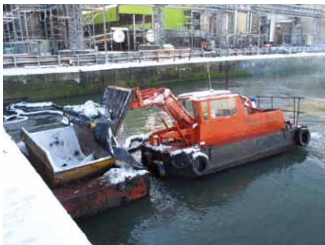
▲ 图 35：自力推进型船，通常用于回收港口中的残骸。在该图中，由于温度低且油类的倾点很高，油类变成半固态，因此需要用勺和抓斗将油类回收漂浮的槽车中。
