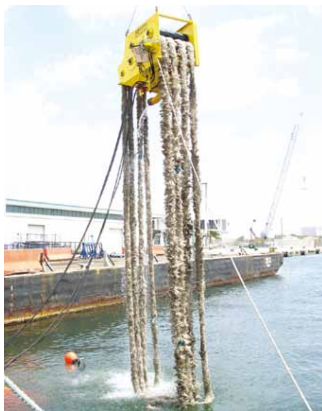
▲ 图 5：自由漂浮的刷式撇浮装置。油类附着在转动的成组刷子上，并从水面上被提起。用一个梳子将油类从刷子上清除到存储容器中。刷子背后的推进装置将浮油推往撇浮装置以提高遇油率和吞吐量（图片由 Lamor 惠供）。
