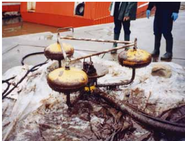
▲ 图 37：回收重质油类后被捞到岸上的导流坝撇浮装置。遭散后，应对设备进行清洗和大修，以备将来使用。
