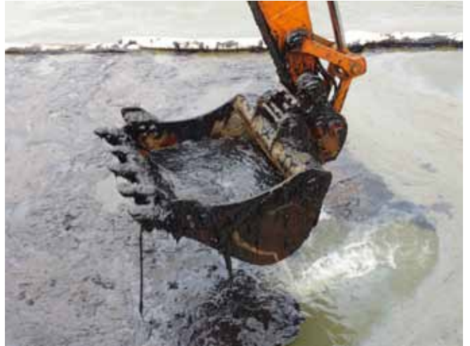
▲ 图 21: 使用挖掘机回收高粘度燃油。通过指示操作员将挖斗在水面上方稍微悬停一段时间,使附连水流掉,最大限度地提高了所回收到的油类的浓度。这样做以牺牲回收效率为代价降低了后续的处置成本。
