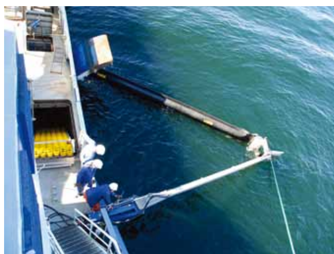
▲ 图 32：一个内置式单船回收系统。存放在舱室中船一侧的栅栏用船上的吊车通过一个开口进行部署。此开口还使得附连水能够通过船载撇浮装置进行回收，本图中的船载撇浮装置由一个传送带装置中的六组刷子构成（图片由 Lamor 惠供）。
