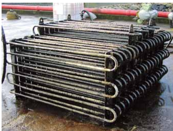
▲ 图 27: 用于帮助将粘稠油类从回收船排放到岸上的便携式加热旋管。
