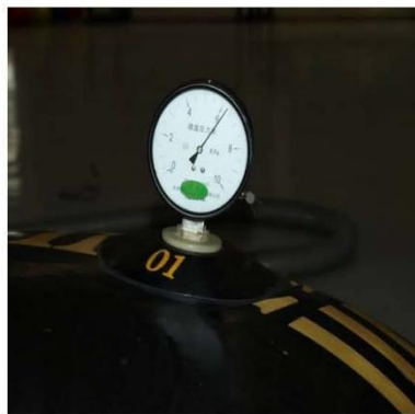
气室气密性检验 ( \geq 6\text{kPa} 、24h)
