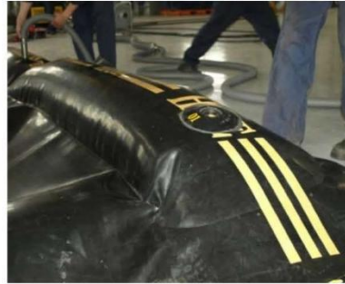
充好气的围油栏气室
