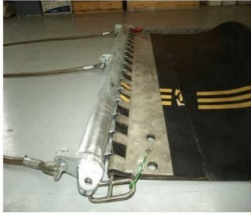
拖绳、卸扣、 拖头、插销等连接在一起
