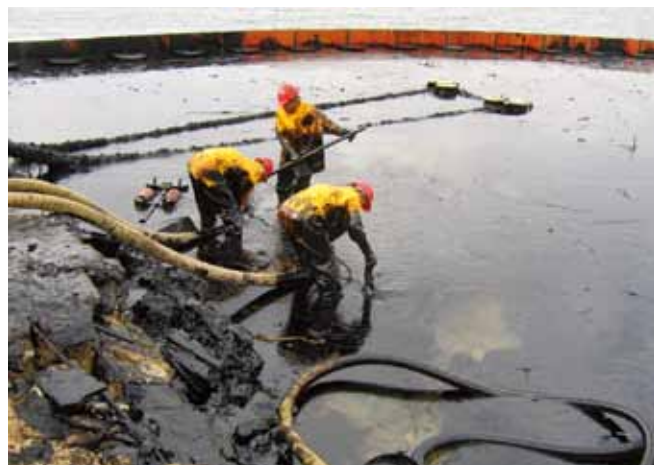
▲ 图 3：使用绳式拖把撇浮装置和真空泵从海岸线回收液态的大片油类。
