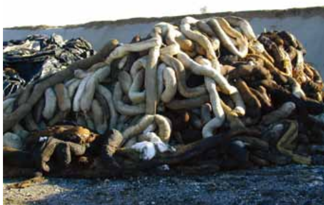
▲ 图 15：使用过的吸油物堆积在临时储放点。挤压将导致回收油从浮木档栅挤出，需要小心处理以避免二次污染。
