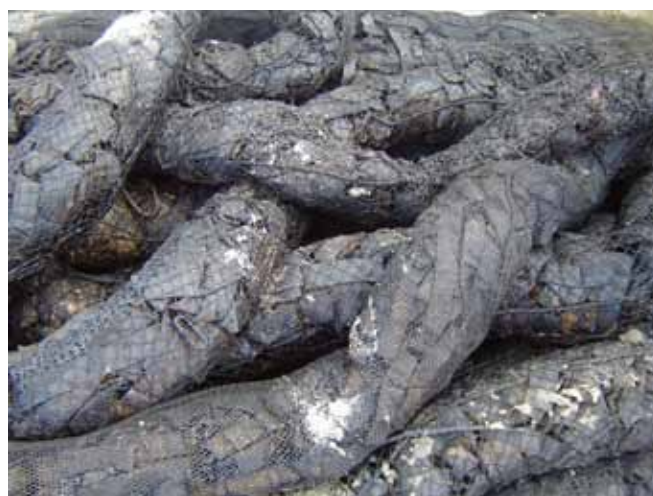
▲ 图 3：包封在编网中的聚丙烯条。浮木档栅松散的不均匀结构能够让油类轻松穿透结构，从而让内表面能够吸附油类，但包封编网很容易损坏。
