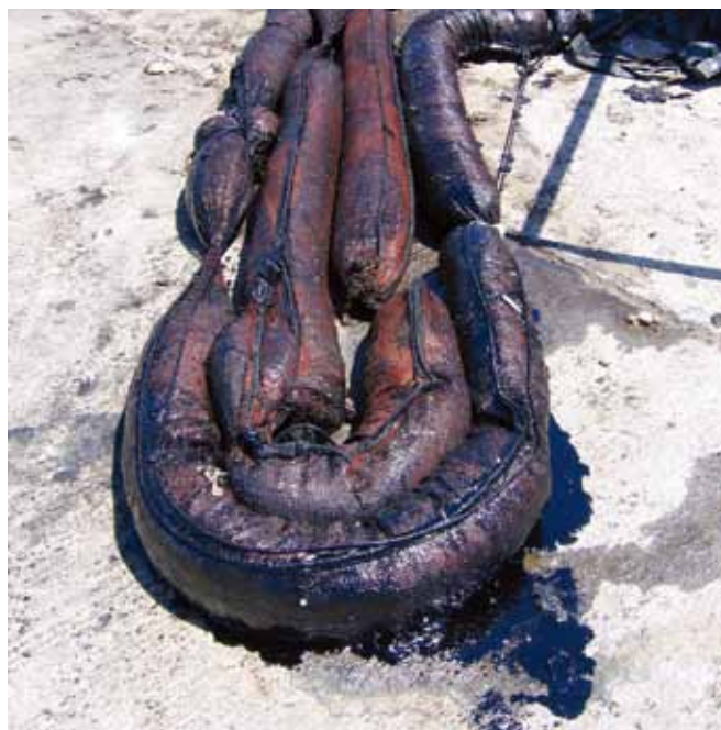
▲ 图 14：回收的吸油浮木档栅中沥出的油类是二次污染源。
